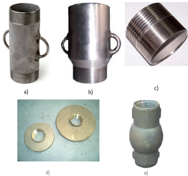
Figura 3 – Outros acessórios: a) canhão de aço inoxidável macho-macho; b) canhão de aço inoxidável macho-fêmea para transição entre a bomba e a coluna; c) adaptador de aço inoxidável (casquilho de transição rosca BSP); d) tampas de furo em latão; e) válvula de retenção a colocar a cada 30 m de coluna
